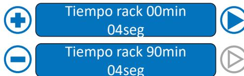
**Paso 11:** Tiempo de lavado activado: para ajustar el tiempo de lavado activado, utilice los botones Más + y Menos –. Confirme su selección pulsando el botón DERECHA >, repita el procedimiento para ajustar los segundos. Una vez terminado, pulse el botón DERECHA > de nuevo para confirmar.
